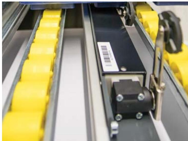
Rollenbahnsensor im montierten Zustand: Die Sensoren zur Erfassung des Materialbedarfs können in Durchlauf-Regalsystemen montiert werden.
